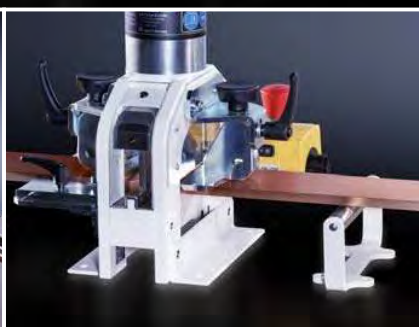
Cortar um barramento
