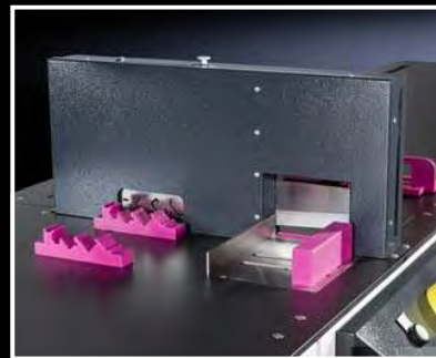
Unidade para cortar trilhos de suporte e canaletas de cabos
