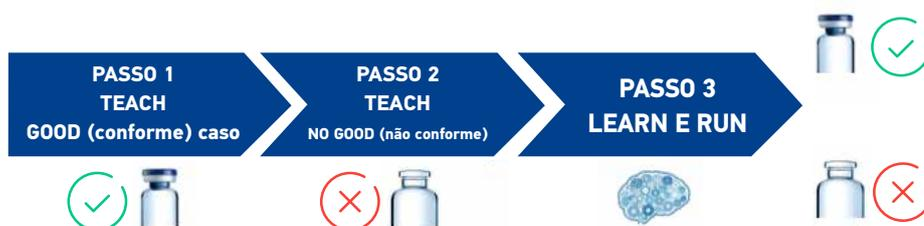
O sensor é especialmente adequado para todas as aplicações em que é necessário resolver a detecção entre duas classes de condição de objeto bem especificadas, como presença ou ausência de um recurso específico ou orientação a objeto em relação aos dois lados, ensinando o sensor com as condições GOOD (conforme) e NO GOOD (não conforme).
